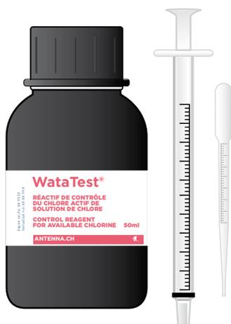
Es esencial controlar la calidad de la solución de hipoclorito de sodio producida para determinar la dosificación correcta a aplicar en función del uso que se le quiera dar.
